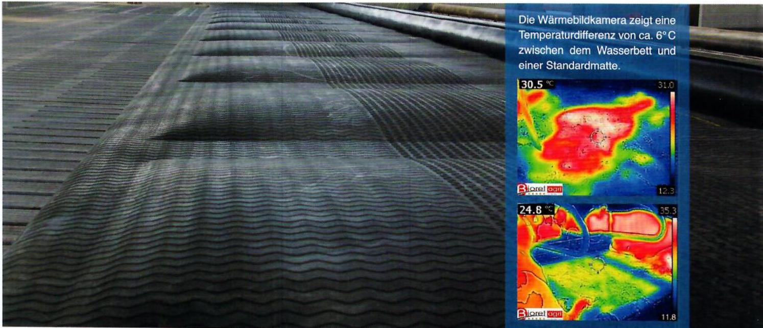
Die Wärmebildkamera zeigt eine Temperaturdifferenz von ca. 6° C zwischen dem Wasserbett und einer Standardmatte.
